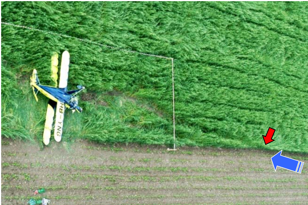
Abbildung 1: Flugaufnahme der Unfallstelle. Der blaue Pfeil bezeichnet die Anflugrichtung, der rote Pfeil den Beginn der Spuren des Hauptfahrwerks.
